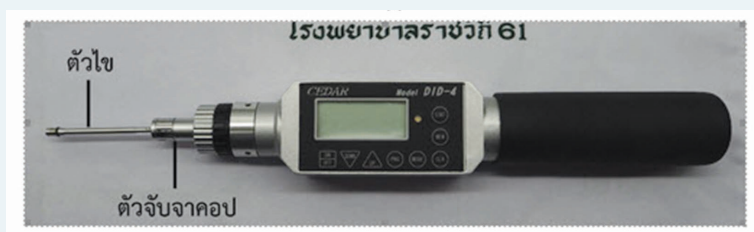
รูปที่ 3 การต่อตัวไขเข้ากับเครื่องวัดแรงบิด
