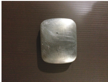
รูปที่ 1 กล่องโลหะสี่เหลี่ยมที่เจาะรูไว้เป็นจุดอ้างอิง 2 รู
