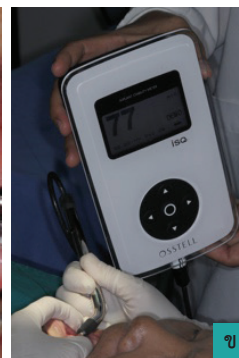
รูปที่ 2 ก) การใช้ส่วนที่ส่งและรับสัญญาณวัดคลื่นความถี่ของเครื่องออสเทลแมนเตอร์วัดค่าเสถียรภาพของรากฟันเทียม ข) เครื่องออสเทลแมนเตอร์แสดงค่าความถี่เรโซแนนซ์
