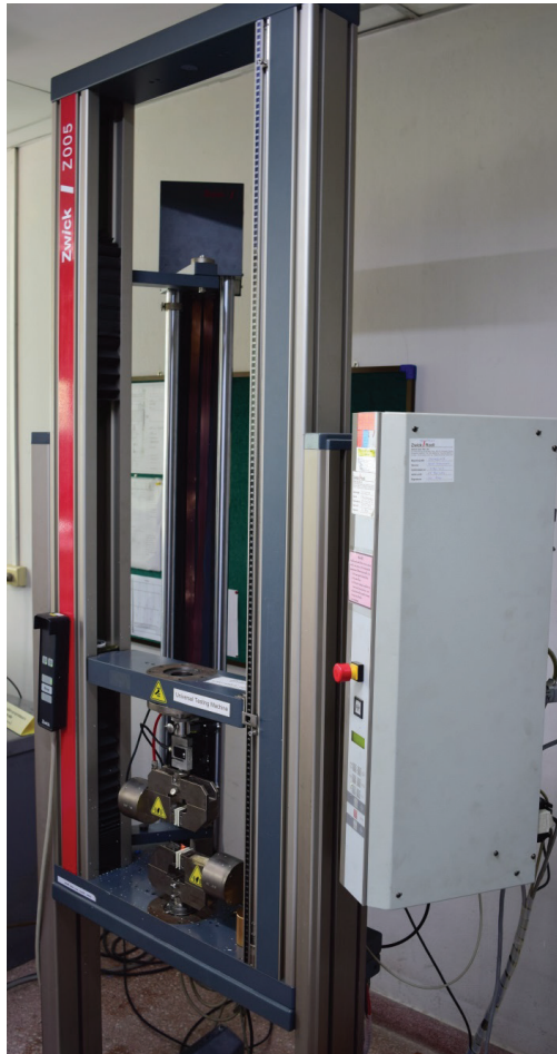
รูปที่ 7 Tensile testing machine Zwick Z005 equipped with optical extensometer สำหรับวัดความต้านแรงดึง ความยืด และความต้านแรงฉีก
