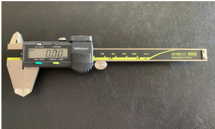
รูปที่ 1 Digital veneer caliper (Mitutoyo , ABSOLUTE AOS)
