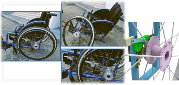
ภาพที่ 1 แสดงต้นแบบอุปกรณ์ช่วยขึ้น-ลงบันไดสำหรับ รถนั่งคนพิการ รุ่นช่วยเหลือตนเอง
