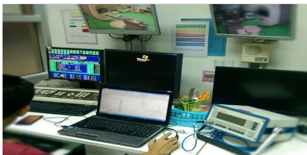
รูปที่ 2 แสดงการวัดค่าปริมาณรังสีจริงใน water phantom โดยอ่านค่าประจุจากเครื่อง electrometer ที่มา : กลุ่มงานรังสีรักษา โรงพยาบาลมะเร็งอุดร
