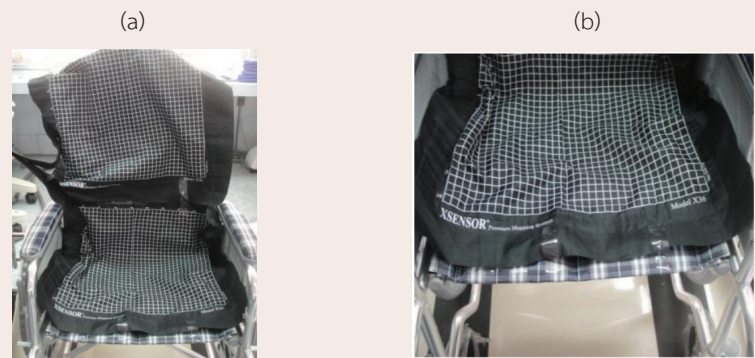
รูปที่ 3 (a) และ 3 (b) เครื่องมือวัดค่าความดันระหว่างผิวสัมผัส (Interface pressure mapping)
