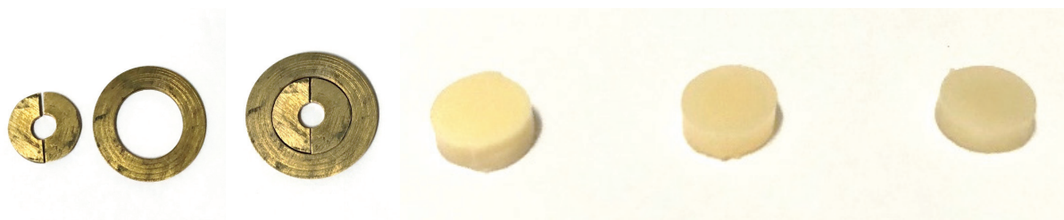
รูปที่ 1 แบบพิมพ์ที่ทำด้วยโลหะขนาดเส้นผ่านศูนย์กลาง 6 มม. หนา 2 มม. และชิ้นทดสอบ เซอริโคโนเมอร์ อิมพรัฟ เรซินคอมโพสิต และไจโอเมอร์ ตามลำดับ
