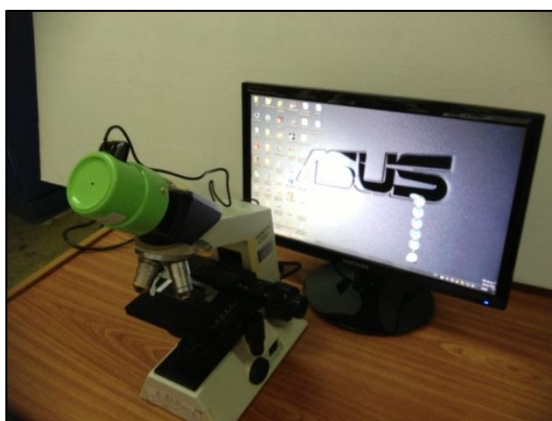
รูปที่ 2 แสดงวิธีการติดตั้ง อุปกรณ์ชุดกล้องประกอบเว็บแคมเพื่อถ่ายภาพจากกล้องจุลทรรศน์
