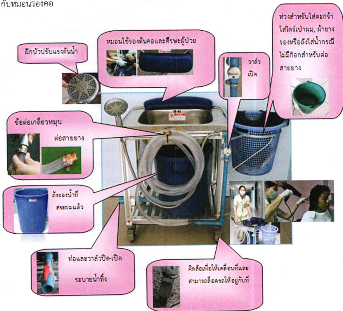
ภาพที่ 3 ขั้นตอนการประกอบรถโมบายสบายแฮร์
