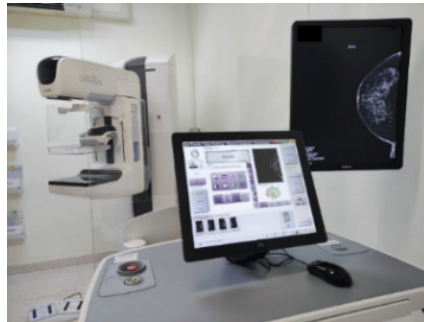
ภาพที่ 1 เครื่องเอกซเรย์เต้านมระบบดิจิตอล เครื่องหมายการค้าฮาโลจิก (Hologic) รุ่น Dimensions
