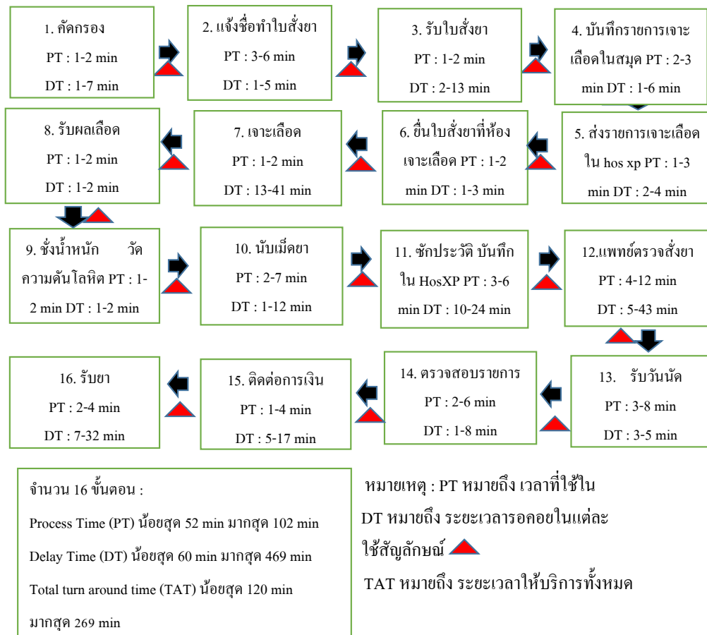
ภาพที่ 1 แผนผังสายธารคุณค่าของการบริการผู้ป่วยปัจจุบัน (Current Value Stream mapping)
