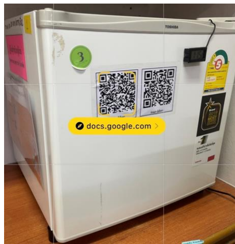
รูปที่ 1 ระบบการบันทึกอุณหภูมิตู้เย็นแช่ยาโดยโปรแกรมประยุกต์ Google form และ QR code
