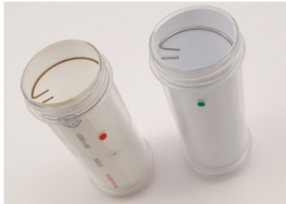
ภาพที่ 1 กระบอทดสอบ exposure tube (ซ้าย) และกระบอทดสอบ holding tube (ขวา) (8)
