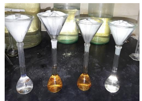
ภาพที่ 1 การวิเคราะห์โลหะหนักโดยใช้เครื่อง Atomic Absorption Spectroscopy (AAS) จากการย่อยสลายกระดวยกรองเก็บตัวอย่างฝุ่น PM 2.5
