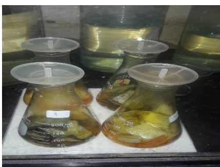
ภาพที่ 1 การวิเคราะห์โลหะหนักโดยใช้เครื่อง Atomic Absorption Spectroscopy (AAS) จากการย่อยสลายกระดวยกรองเก็บตัวอย่างฝุ่น PM 2.5
