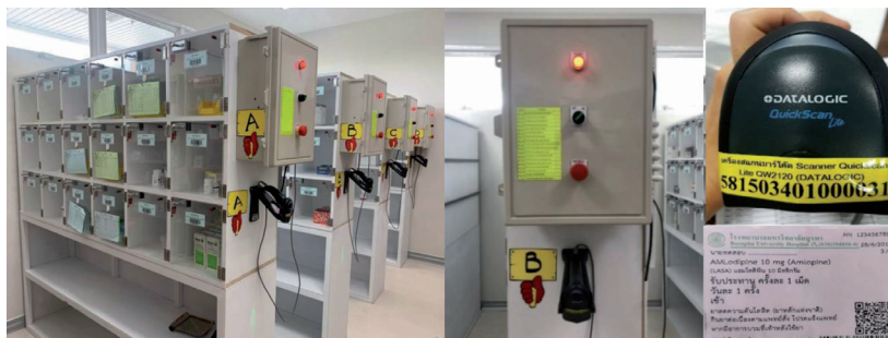
รูปที่ 1 ลักษณะชั้นวางยาที่ควบคุมด้วยระบบบาร์โค้ด (LASA Safety shelf) กล่องควบคุมเครื่องสแกนบาร์โค้ดที่ใช้ประกอบและฉลากยา
