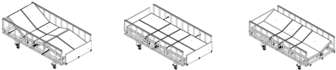
รูปที่ 1 ลักษณะเตียงพลิกตะแคงตัวแบบมือหมุนที่พัฒนาขึ้น
