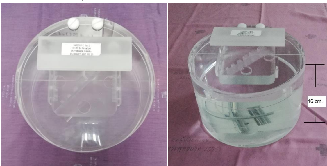
รูปที่ 2 หุ่นจำลอง Helios QA phantom ที่มา: กลุ่มงานรังสีวิทยา โรงพยาบาลพระพุทธบาท
