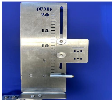
ภาพที่ 3 เลเซอร์ตั้ง zero point บนแผ่นสเกลวัดระดับ
