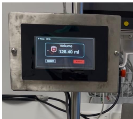
ภาพที่ 6 เชื่อมต่อจอแสดงผล (HMI) เข้ากับเสาน้ำเกลือ
