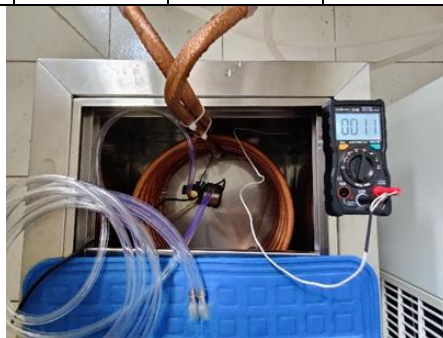
ภาพที่ 1 ระบบภายในของเครื่องประคบเย็นอัตโนมัติ
