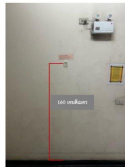
ภาพที่ 2 การติดตั้งชุดอุปกรณ์วัดก๊าซเรดอนในอาคารที่ระดับ 160 เซนติเมตร
