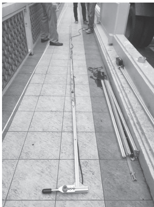
เครื่องมือวัดอัตราการไหลของน้ำ ประเภท Electromagnetic : AEM1-D
