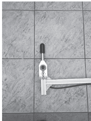
เครื่องมือวัดอัตราการไหลของน้ำ ประเภท Electromagnetic : AEM1-D
