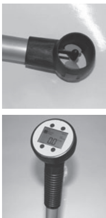
เครื่องมือวัดอัตราการไหลของน้ำ ประเภท Magnetic : FP-01 1212
