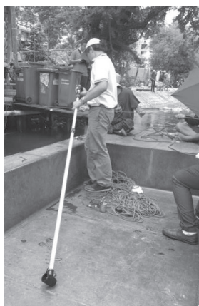
เครื่องมือวัดอัตราการไหลของน้ำ ประเภท Magnetic : FP-01 1212
