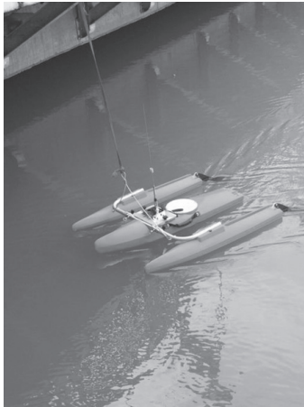
เครื่องมือวัดอัตราการไหลของน้ำ ประเภท Acoustic Doppler Current Profiler (ADCP) : River Ray
