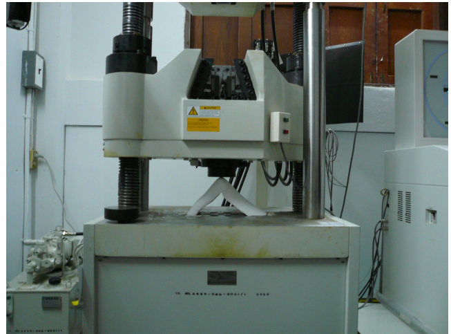
รูปที่ 4 แสดงการทดสอบแรงกดในแนวคดงอ 3 จุด
