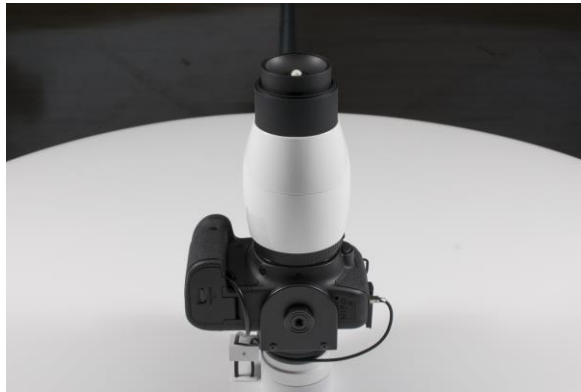
ภาพที่ 4 กล้องถ่ายภาพ DSLR ประกอบด้วยเลนส์ตาหนู
