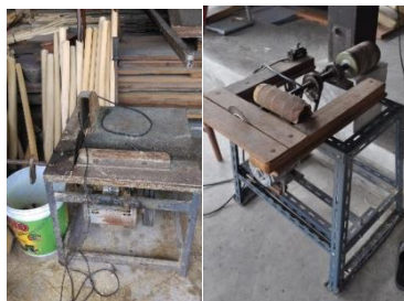
ภาพที่ 8 เครื่องตัดและขัดกระดาษทรายที่ช่วยทุ่นแรงการผลิต
