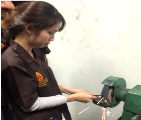
รูปที่ 4 ทดลองลับมีดกลึงตามใบงานที่มอบหมาย
