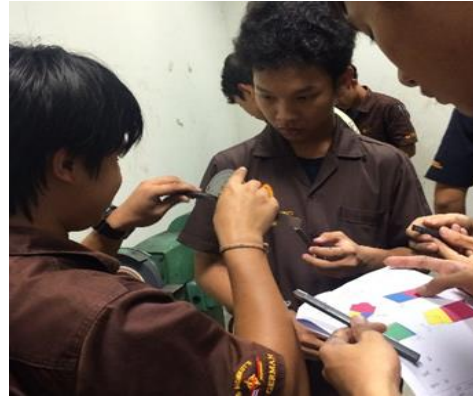
รูปที่ 5 ตรวจสอบมุมมีดกลึงตามมาตรฐานในใบงาน
