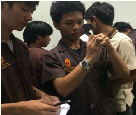
รูปที่ 6 ตรวจสอบมุมมีดกลึงตามมาตรฐานในใบงาน
