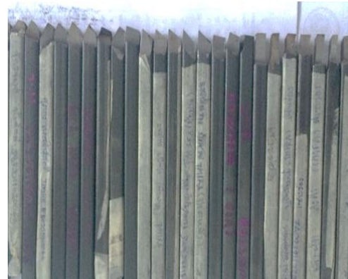
รูปที่ 7 ผลการทดลองลับมีดกลึงตามใบงาน
