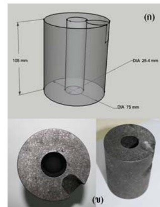
ภาพที่ 2 (ก), (ข) ขนาดและรูปร่างคอลลิเมเตอร์ ของหัววัดรังสีเอกซ์
