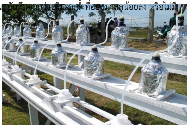
รูปที่ 1 ชุดการทดลองหาปริมาณก๊าซที่เกิดขึ้นจากการหมักตะกอนในสภาวะไร้อากาศโดยอาศัยหลักการ fluid displacement
