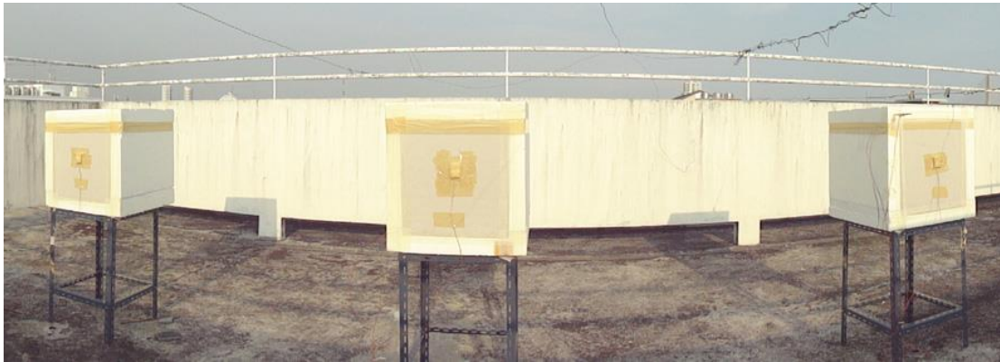
ภาพที่ 4 แสดงการทดสอบความสามารถในการป้องกันความร้อนด้วยกล่องทดลอง
