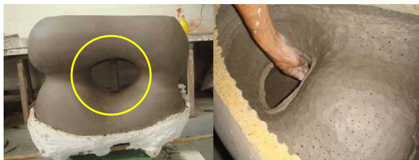
ภาพที่ 28 การล้าบริเวณที่คาดว่าจะเป็นจุดแตกและเสริมเนื้อดินบริเวณด้านในเพื่อเพิ่มความแข็งแรง
