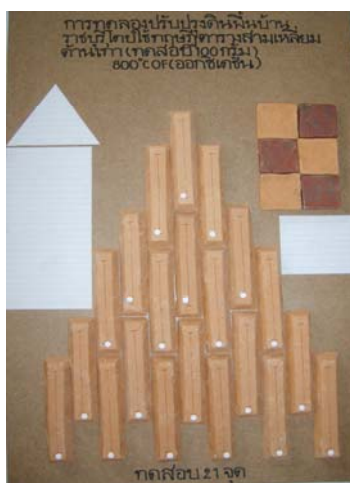
ภาพที่ 9 แผ่นทดลองการปรับปรุงดินพื้นบ้านราชบุรี โดยใช้ทฤษฎีสามเหลี่ยมเผาที่อุณหภูมิ 800 องศาเซลเซียส ถ่ายภาพโดย บุรินทร์ อินทะแสน
