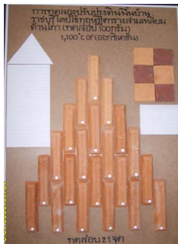
ภาพที่ 10 แผ่นทดลองการปรับปรุงดินพื้นบ้านราชบุรี โดยใช้ทฤษฎีสัมเหลี่ยมเผาที่อุณหภูมิ 1,100 องศาเซลเซียส ถ่ายภาพโดย บุรินทร์ อินทะแสน
