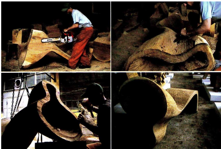
ภาพที่ 20 ลักษณะการผลิตต้นแบบ (Prototype) เครื่องเรือนโดยการแกะไม้จริง นักออกแบบต้องมีทักษะกลวิธีทางประติมากรรมเป็นอย่างดี, ที่มา: Hudson, Jennifer. Process: 50 product design from concept to manufacture . (London: Laurence King, 2008), 87.
