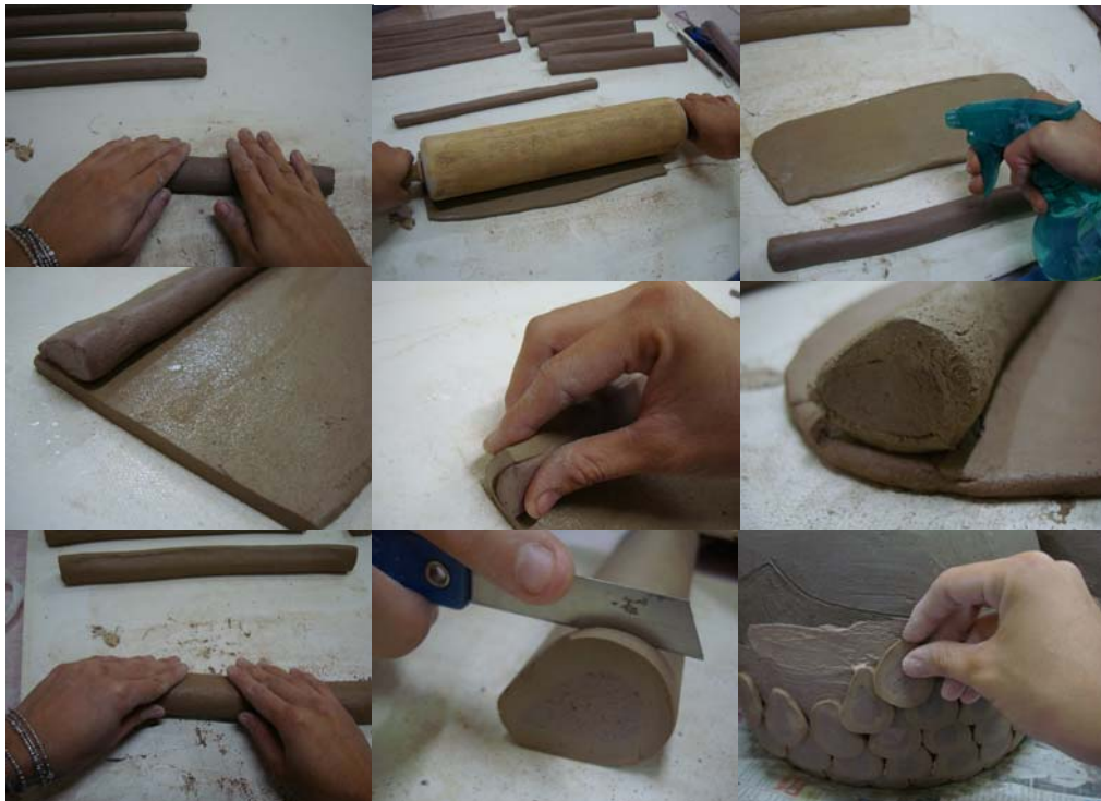
ภาพที่ 10 ขั้นตอนการทำเทคนิคการจัดเรียงดินสลับชั้นสี
