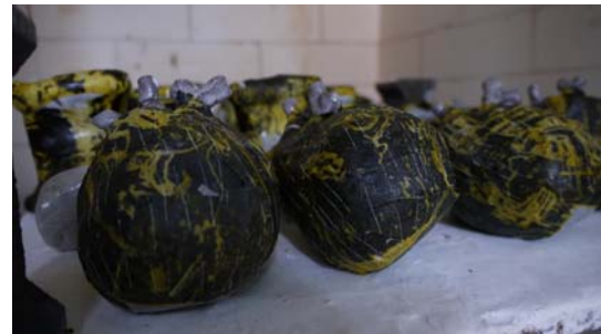
ภาพที่ 12 ขั้นตอนการบรรจุเข้าเตาเผา เพื่อให้สีสกรีนที่ติดลงบนชิ้นงาน โดยเผาบรรยากาศ oxidation อุณหภูมิ 1200 องศาเซลเซียส ใช้เวลาประมาณ 10 ชั่วโมง ที่มา : จากการศึกษของผู้วิจัย
