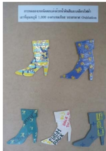
ภาพที่ 10 ผลการทดลองการตกแต่งด้วยน้ำดินสี เคลือบใสไฟฟ้าที่อุณหภูมิ 1,000 องศาเซลเซียส ที่มา : ภาพถ่ายโดยผู้วิจัย
