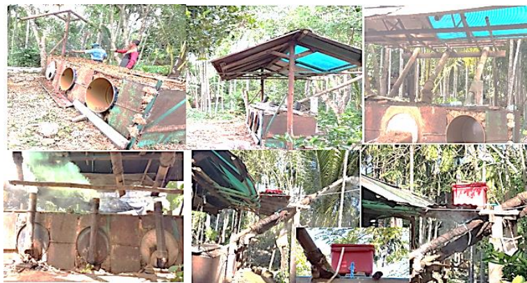
ภาพประกอบ 1 ติดตั้งเตาเผาถ่าน 200 ลิตร และระบบหล่อเย็น
