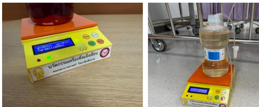
ภาพที่ 4 แสดงรูปแบบเครื่องแจ้งเตือนสารน้ำที่พัฒนาขึ้น
