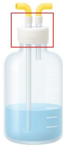
ภาพที่ 2 การติดพลาสติกบริเวณรอยต่อของสายระบายทุกจุด
