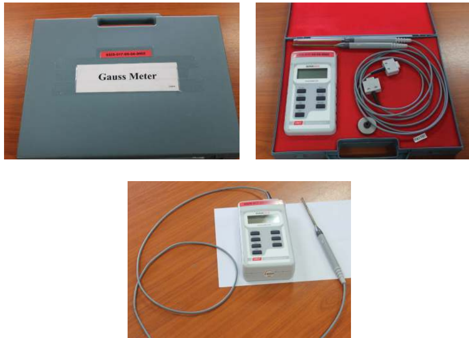
ภาพที่ 1 เครื่อง Gauss meter ที่ใช้สำหรับวัดความเข้มสนามแม่เหล็ก
