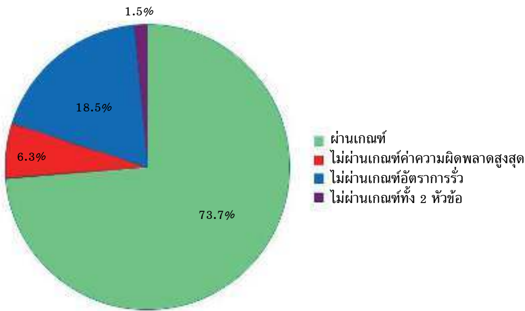
ภาพที่ 5 สัดส่วนร้อยละของเครื่องวัดความดันโลหิตแบบเชิงกล จำแนกตามหัวข้อทดสอบ ที่ไม่ผ่านเกณฑ์ยอมรับ
