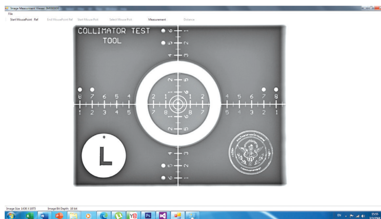
ภาพที่ 12 ภาพถ่ายรังสีหลังทำการปรับความคมชัด (Contrast) และปรับความสว่าง (Brightness)
