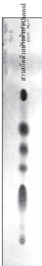
ภาพที่ 3 โครมาโตแกรมของสารสกัดจากเมล็ดเทียนแดงด้วย ethanol ตรวจสอบด้วยน้ำยาพ่น anisaldehyde TS
