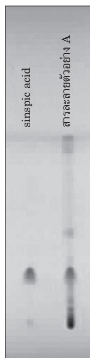
ภาพที่ 5 โครมาโตแกรมของสารสกัดจากเมล็ดเทียนแดง (สารละลายตัวอย่าง A) เปรียบเทียบกับสารมาตรฐาน sinapic acid ตรวจสอบภายใต้แสงอัลตราไวโอเล็ต ที่ความยาวคลื่น 254 นาโนเมตร
