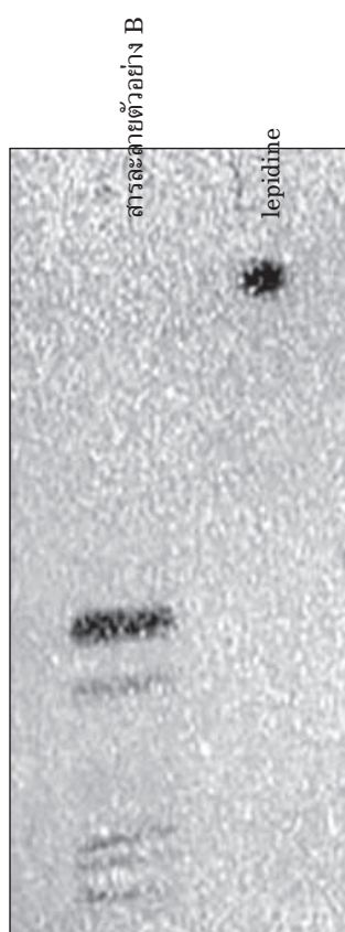
ภาพที่ 8 โครมาโตแกรมของสารสกัดจากเมล็ดเทียนแดง (สารละลายตัวอย่าง B) เปรียบเทียบกับสารมาตรฐาน lepidine ตรวจสอบด้วยน้ำยาฟันทิโอดิแพลทินาต TS
