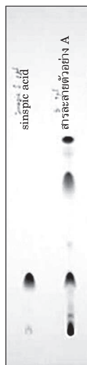
ภาพที่ 6 โครมาโตแกรมของสารสกัดจากเมล็ดเทียนแดง (สารละลายตัวอย่าง A) เปรียบเทียบกับสารมาตรฐาน sinapic acid ตรวจสอบโดยการอ้งไอของ iodine
