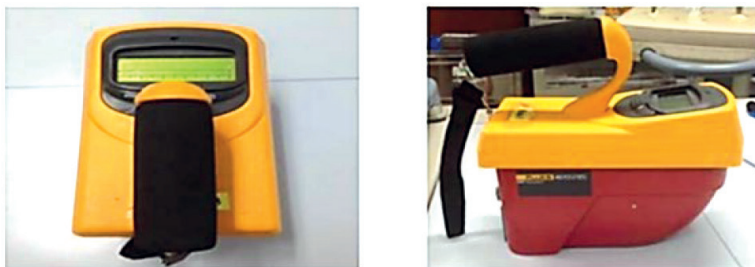
ภาพที่ 1 เครื่องสำรวจรังสี (Survey meter) ยี่ห้อ Fluke รุ่น 451P-DE-SI-RYR S/N: 6608
