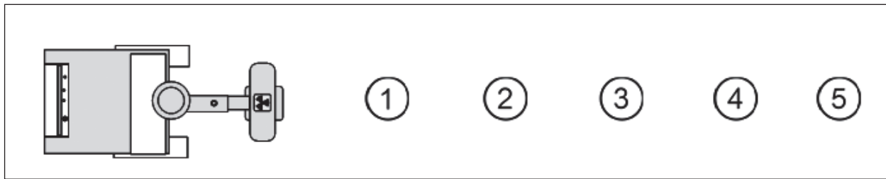
ภาพที่ 1 แสดงตำแหน่งที่วัดปริมาณรังสีกระเจิง ณ ตำแหน่งที่ 1-5 เมตร (มองจากด้านบน)
