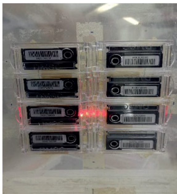
ภาพที่ 3 แผ่นวัดรังสีไอเอสแอล InLight ® BasicXA บรรจุใน DMSc holder ติดบน ISO water slab phantom
