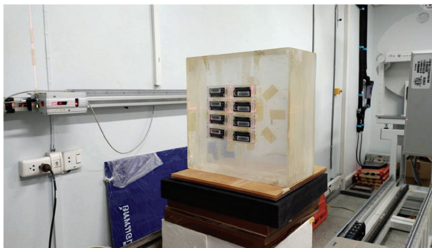
ภาพที่ 5 หุ่นจำลอง slab phantom
