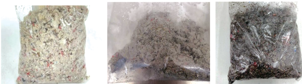
ภาพที่ 2 ตัวอย่างของมูลฝอยหลังจากผ่านเครื่องย่อยไมโครเวฟ
