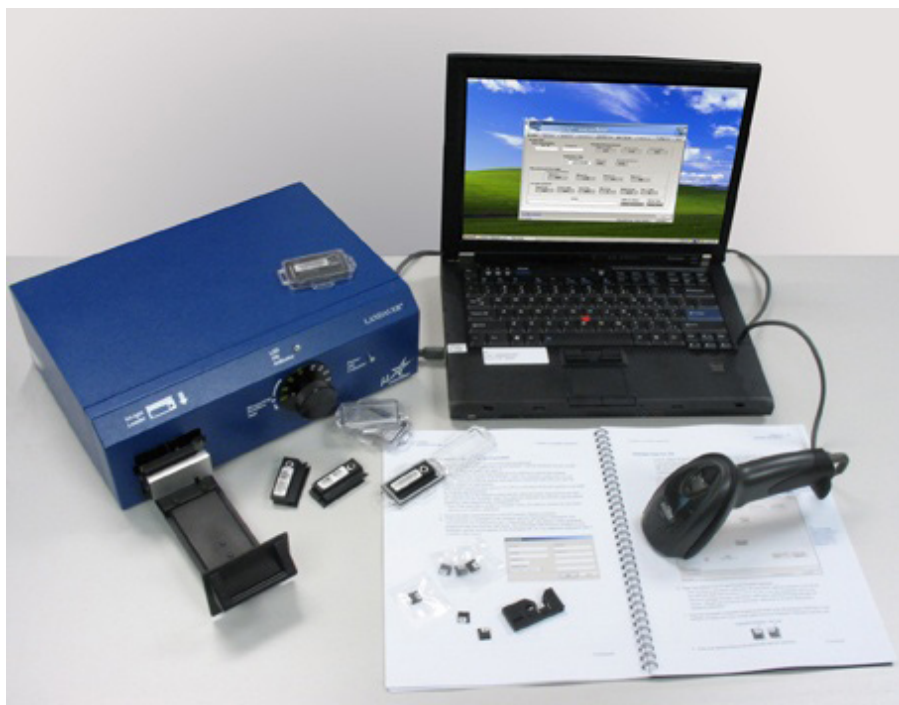
ภาพที่ 4 เครื่องอ่านแผ่นวัดรังสี microStar และโปรแกรมประเมินผลปริมาณรังสี microStar
