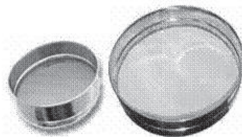
ภาพที่ 1 ตะแกรงทำจาก stainless steel
